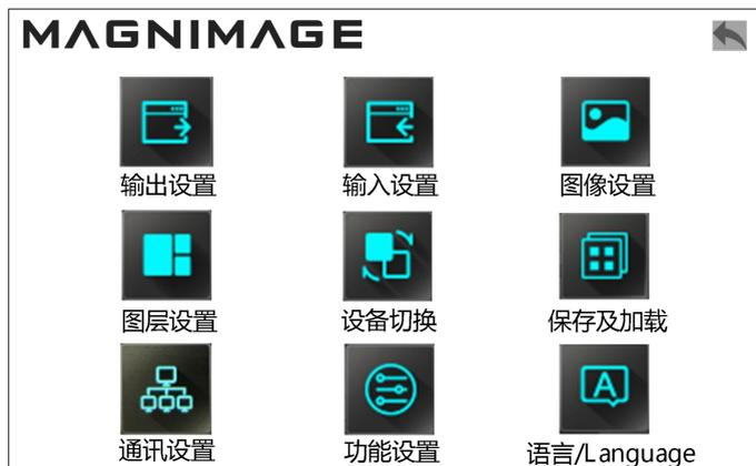
主菜单共 9 个菜单项目，可用旋钮选择上述所列的 9 个菜单标题，未选中的菜单图标字体颜色为蓝色，选中的菜单图标字体颜色为黄色，选定后，按下“OK”键进入所选项目，按下“↩”键返回上一级菜单，或用触摸点击进入相应的菜单。
