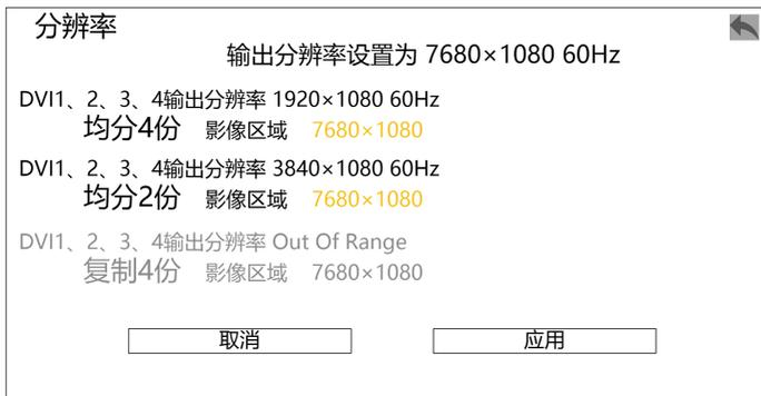
输出口均分整屏分辨率，整机最大输出宽度 7680 像素，所以三个 DVI 口或四个 DVI 口输出拼接切换时，单口最大带载不超过 1920 宽。输出分辨率设置为最大发送卡带载宽度的 2 倍（两口拼接切换）或者 4 倍（三或四口拼接切换）
