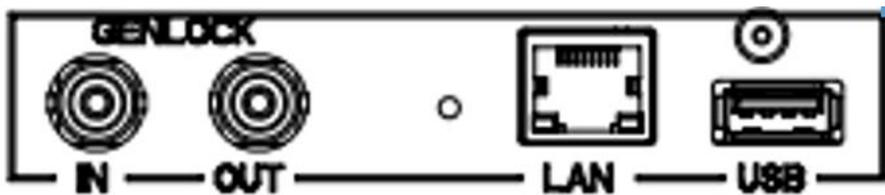
接口: RJ45 网口×1、USB 升级×1、RS232 接口×1、Genlock IN/OUT 各一个.
