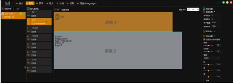
注意：拼接模式下，单个输出口只支持一个图层，跨输出占图层；
